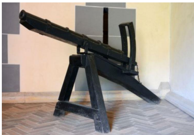
Fig. 3.5 - Una spingarda: “La spingarda è uno dei primi pezzi di artiglieria funzionanti a polvere da sparo. Ha canna corta, che ne facilita la manovra, e piccolo calibro; per sparare, deve essere appoggiata su cavalletti bloccati posteriormente. Alla fine del XV secolo le armi da fuoco, dapprima poco efficaci e sicure, raggiungono un alto livello tecnologico che permette loro di eccellere nei combattimenti del secolo seguente. Le spingarde nella rocca riproducono un originale del XV secolo proveniente da Vercelli che, nel 1883, era collocato nel cortile dell’Arsenale militare di Torino. Furono realizzate su commissione del Ministero della Guerra, espositore all’Esposizione Generale Italiana del 1884.” ( http://www.borgomedievaletorino.it/scheda_opera-39.html?pag=1015 )
